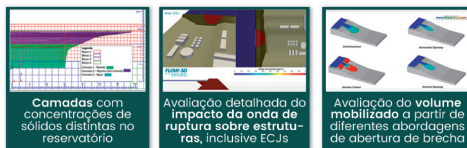
Figura 8 | Aplicações de modelos 3D para estudos de ruptura hipotética
